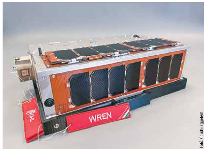
A WREN-1 a talaj felső rétegének nedvességtartalmát és a növényzet fejlődését vizsgálja
