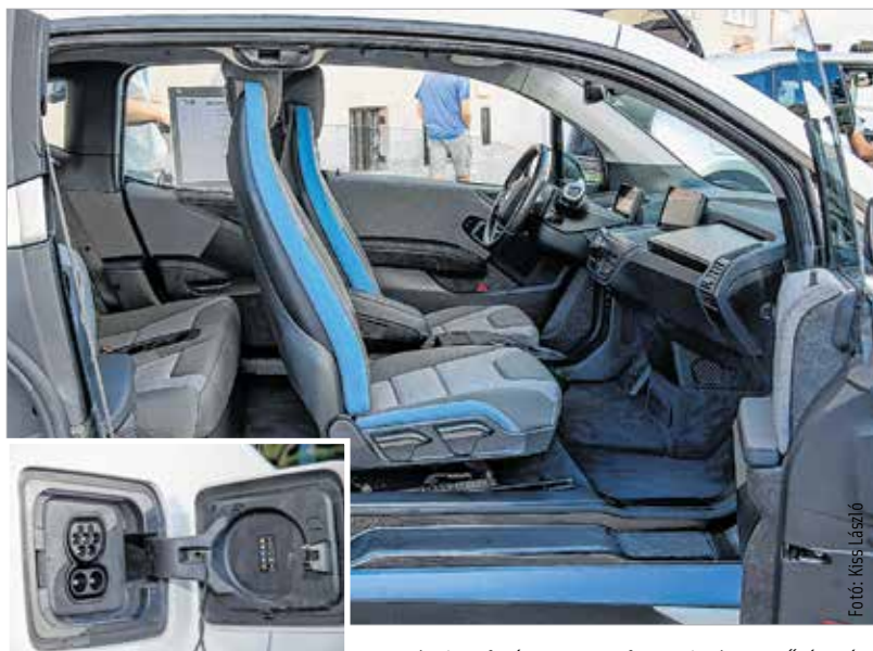
A benzintank helyén csatlakozó van
