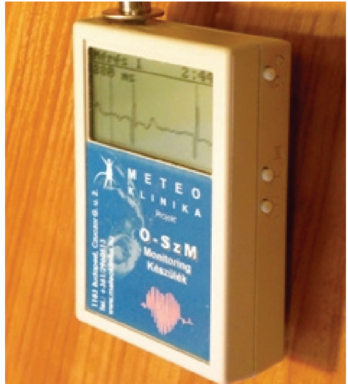
1. ábra: Az ICI Interaktív Zrt. saját fejlesztésű szív működés-monitorozó 3D modellje és legyártott kísérleti sorozatú berendezése
