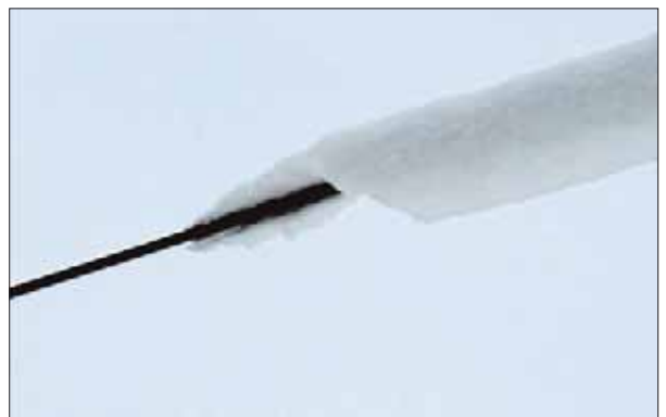
1. kép: Szabadvezetéken kialakult, körszimmetrikusan lerakódott tapadó hó.
