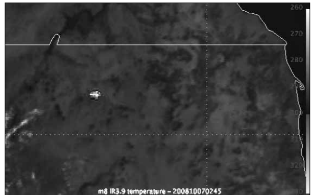
6. ábra: IR3.9 képen a meteor becsapódása. A skála a hőmérsékletet mutatja Kelvin fokban. A kép helyi területi felbontása 3,4 km. (Forrás: Hans Peter Rösli, EUMETSAT)
