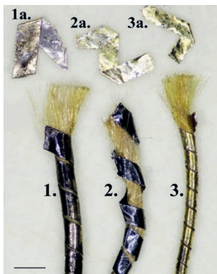
4. ábra. Különböző mértékben korrodálódott aranyozott ezüstfonalak és a felhasznált fémszalagok egy-egy letisztított darabja. Optikai mikroszkópos felvétel, marker 0,5 mm
