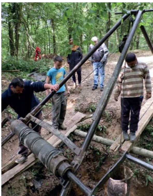
4. ábra. A feltáráshoz szükséges kútásó felszerelés
