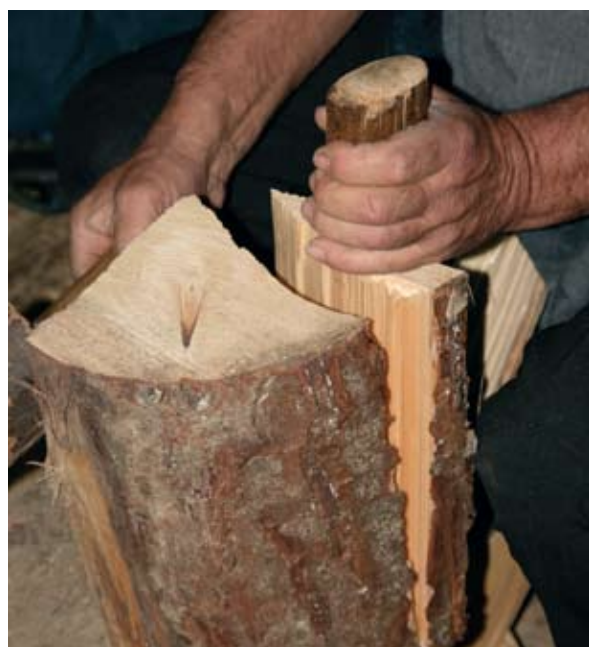
8. ábra. Zsindely-alapanyag kihalászása egy fenyőrönkből recens felvételen
