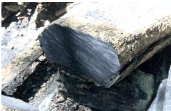
1. ábra. Gerendavég a minta lefűrészelése után
