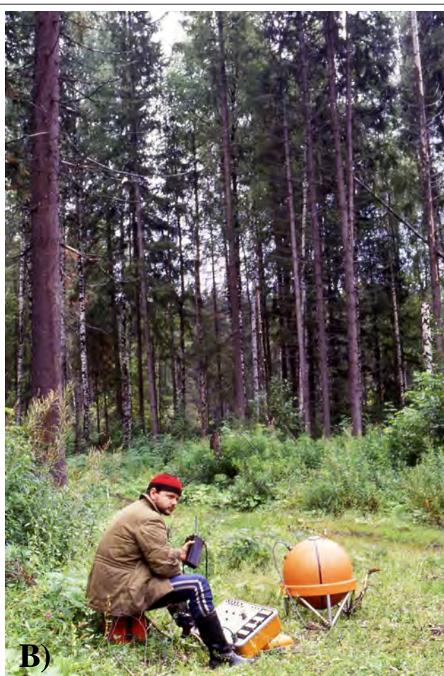
1. ábra. A felszín beszakadása az édesvíz által kioldott és oldatban eltávozott sótömb felett. (A) Elektromágneses (Maxi-Probe) mérés a tajgában, az adó oldal (B)
