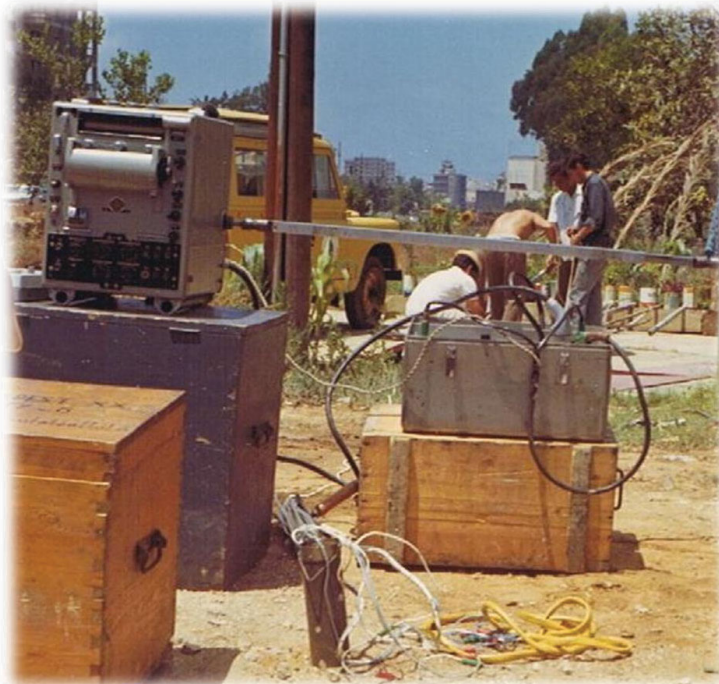
Szlabóczky Pál: Mérnökgeológiai karotázs – Ipari kutatási példatár, Miskolc, 2022 Hordozható kisméretű karotázsszerelés
