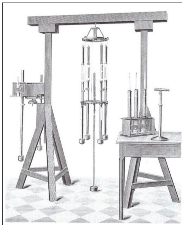
1. ábra | Az O. Hecker által használt „graviméter” Figure 1 | The „gravimeter” used by O. Hecker
