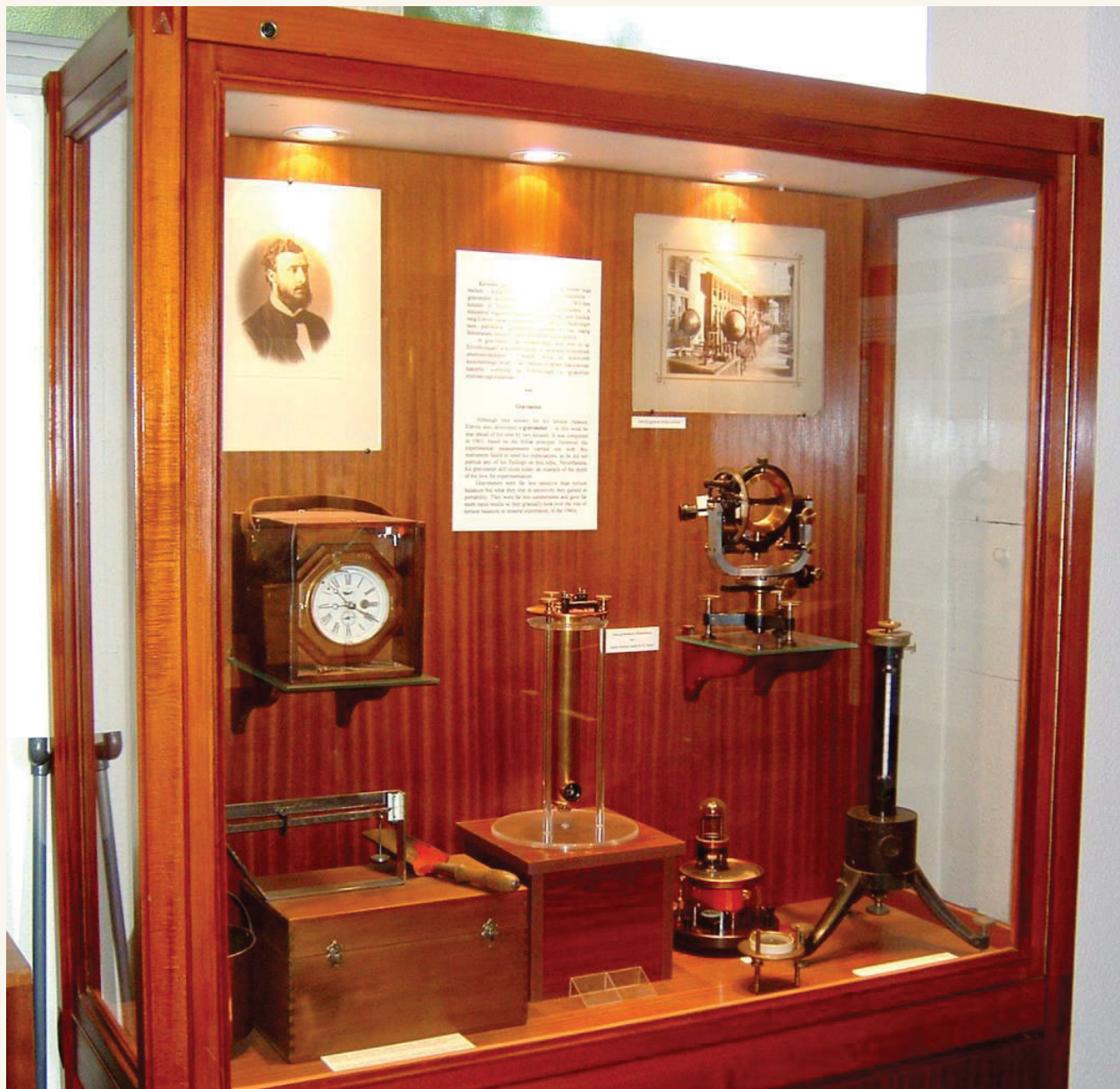
Eötvös Loránd 1901-ben elkészült és kipróbált gravimétere az egykori Eötvös Loránd Geofizikai Intézet által berendezett báró Eötvös Loránd Emlékiállításon (A graviméter az üvegtároló közepén látható)
