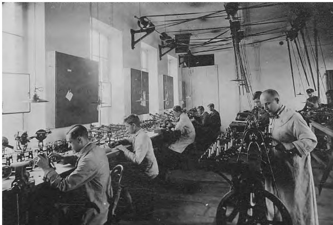
Geodéziai műszerek szerelése a Süss-gyár műhelyében az 1920-as években
