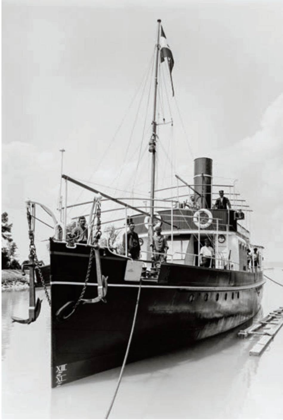
A Jókai utasszállító csavaros gőzhajó (épült: 1913), próbautója előtt Fortepan, Magyar Műszaki és Közlekedési Múzeum / Történeti Fényképek Gyűjteménye / Óbudai Hajógvár Gyűjteménye Lejtői jelzet: N215
