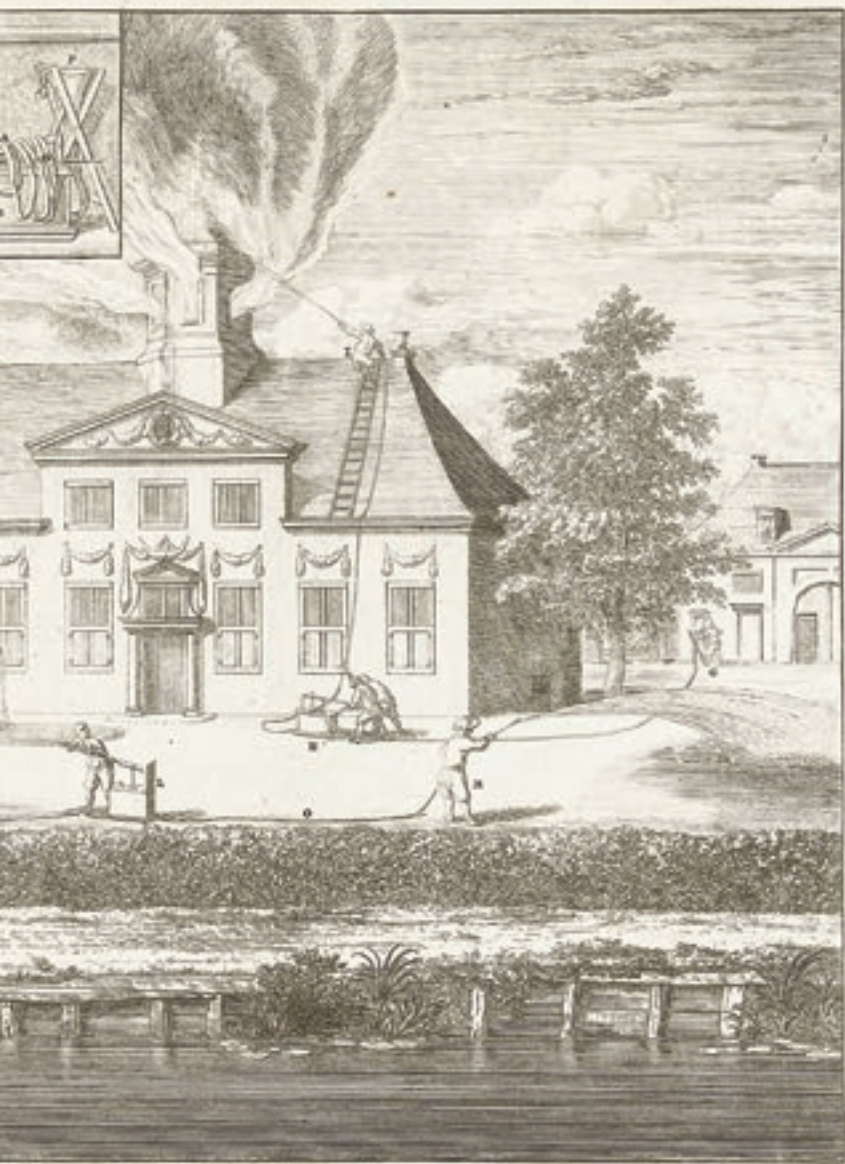
Spangis, Figure des Petites Pompes à Beuzans, appropriées pour les Maisons melle en de Campagne, tant pour y Servir contre les Embrasemens, que Mignon. pour arroser les Jardins, les Plantes et les Arbres. Inventées Jugo. par Jean van der Heyde le Père et le Fils, Intendants généraux des Inondés à Amsterdam.
