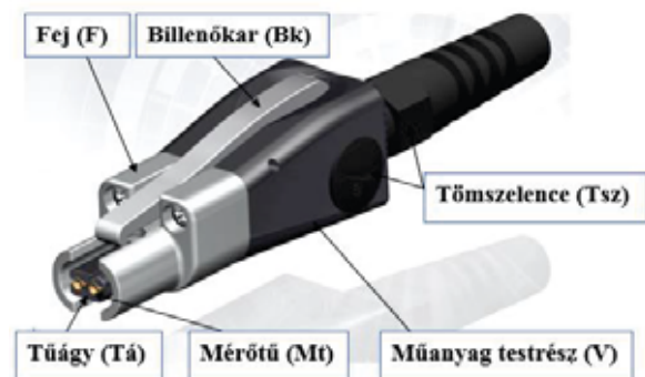
2. ábra. A diagnosztikai csatlakozók általános felépítése
