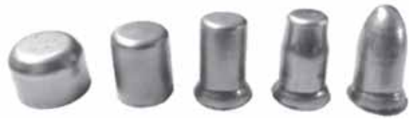
11.kép Véglegesített szerszámból kiesett darabok
