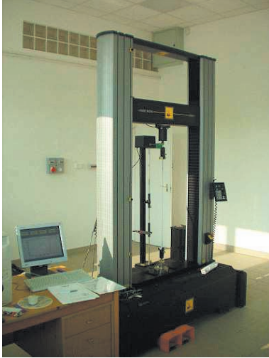
7. ábra. Az Instron 5581-es anyagvizsgáló gép
