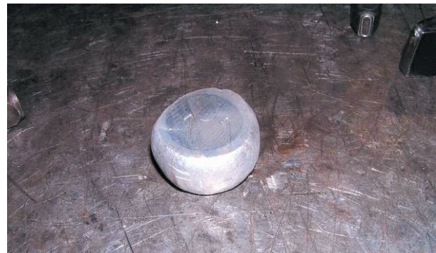
1. ábra. Süllyesztékes kovácsolással gyártott próbatest
