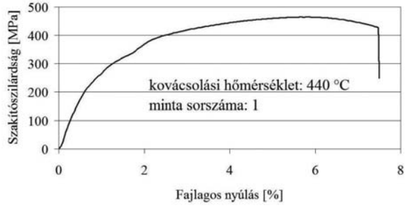
9. ábra. 440 °C-on kovácsolt EN AW 2017 alumínium szakítódiagramja
