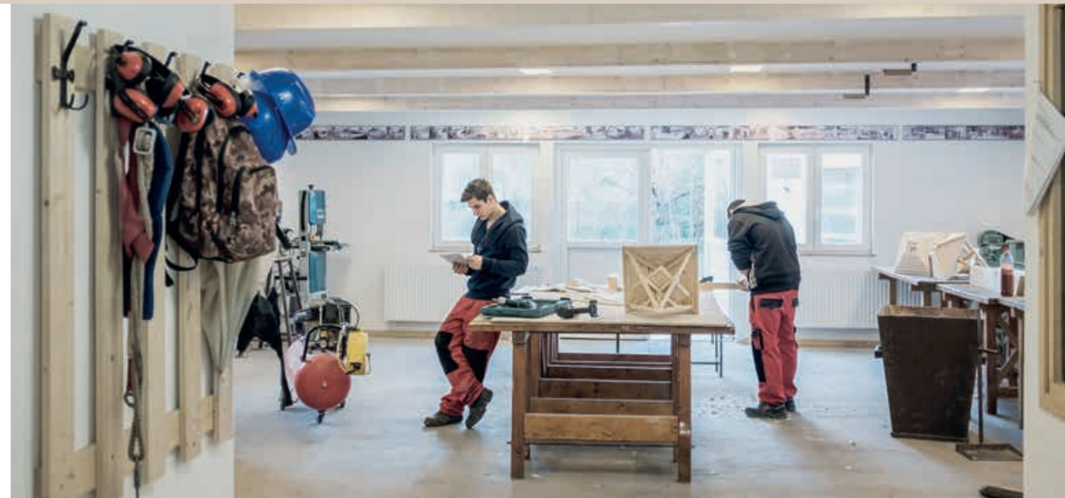
Egy tetőszerkezet kicsinyített mása készül az ácsműhelyben. Az épületet, amelyben gyakorolnak, a diákok maguk készítették – két mesterük segítségével.
