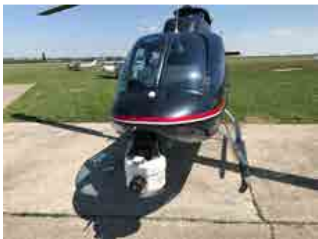
Riegl VP-1 VUX LiDAR egység helikopterre szerelve
