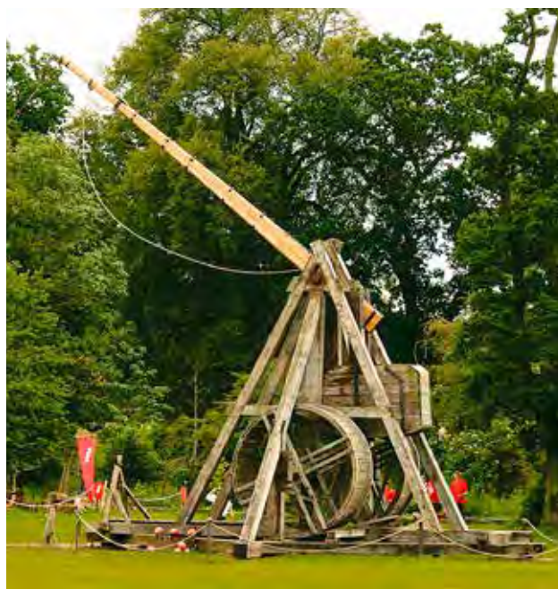
A dél-angliai Warwick kastélynál épített „Warwolf”, amely egy 22 tonnát nyomó ellensúlyos hajítógép
