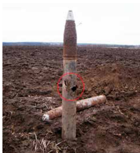
Előtalált magyar 1929/33 M repeszgránáttöltény (elől), 1929/32 M légvédelmirepszgránát-töltény (hátsó). A repeszgránát hüvelyén jól láthatóak a repesztalálat nyomai
