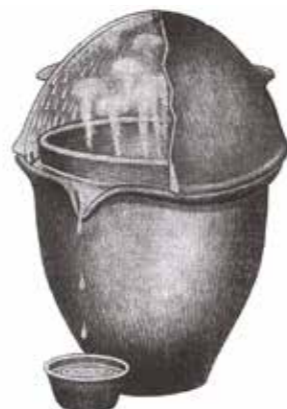
Pálinkalepárló készülék rekonstrukciós rajza
