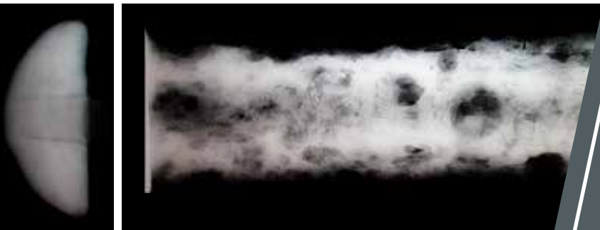
A természettudományos vizsgálatok által jobban megismerhetjük a tárgyak készítése technikáját. A képen egy Mikulčicéről (Morva Fejedelemség) származó viking kori vasberakásos kard fénykép- és röntgenfelvétele szerepel (fotó: Jiří Hošek)
