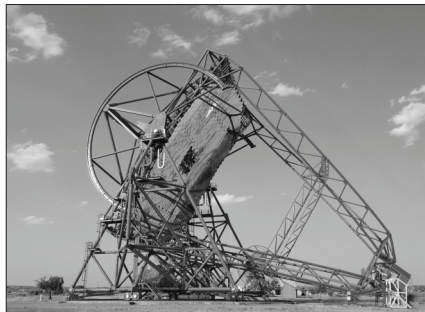
A HESS projekt óriási távcsőve a legnagyobb optikai eszköz a világon – a gamma-sugárzás légkörben keletkező utófényvillanásait detektálja
