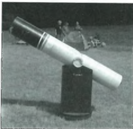
A 200/1500-as Dobson-távcső a 2002-es ágasvári ifjúsági táborban. Az okulár környéke azért kapott fekete festést, hogy a tibusz faláról visszaverődő szórt fény ne zavarja az észlelőt
