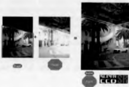
6. ábra. A szuper CCD egy képe valójában két kép összege
