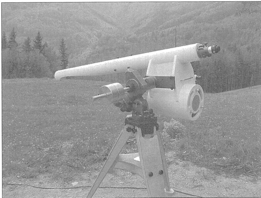
A cikkben említett ferdetűkrős rendszer (Kutter-távcső)
