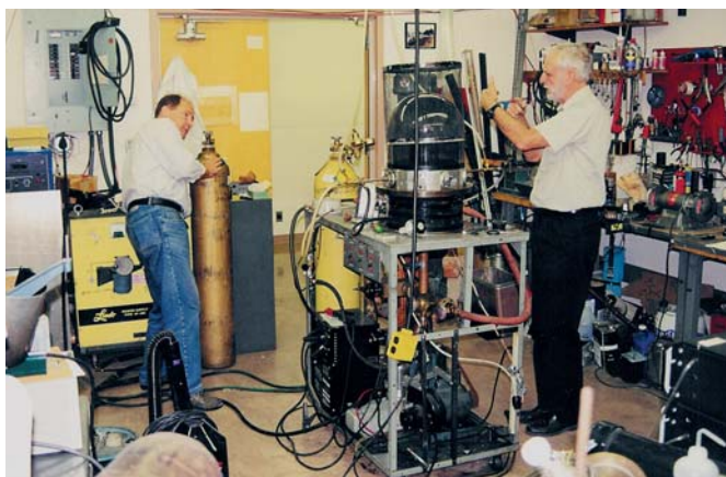
Krätschmer beállítja a szükséges héliumnyomást, Huffman felkészül a kísérlet beindítására
