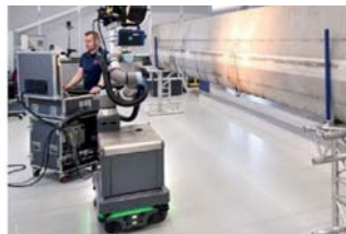
digitális radiográfias képek készítése
