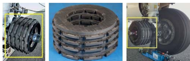
12. ábra. Szén-szén kompozittárcsák a repülőgépkerék-fékben
