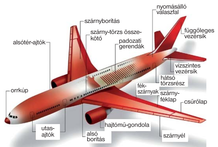
8. ábra. Kompozitalkalmazások a repülőgépen
