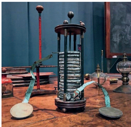
6. ábra. A Volta-oszlop (cink- és ezüstkorongok sora egymásra rakva, egy-egy cink-ezüst párost sóoldattal átitatott filc vagy kartonpapír választ el)
