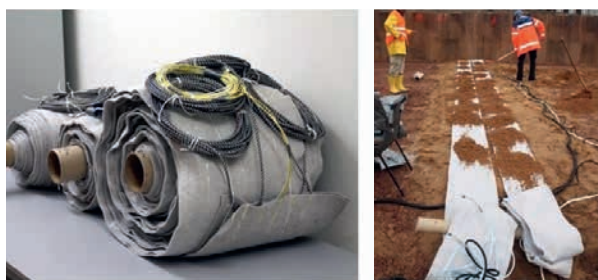
8. ábra. Jeladásra és jeltovábbításra alkalmas innovatív textilszerkezet felépítése és elhelyezése
