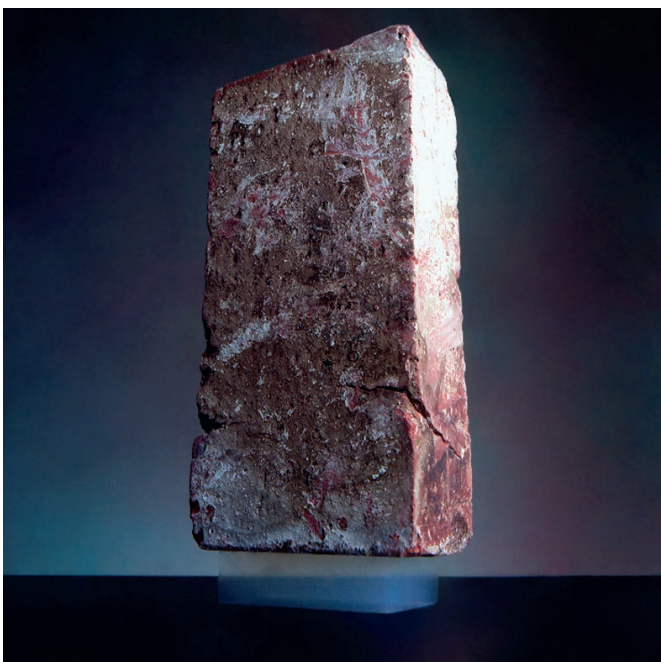
3. ábra. Építési (2,5 kg-os) téglát megtartó 0,2 g-nyi aerogél [7]
