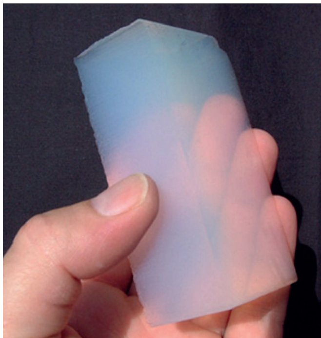
1. ábra. Szilícium-dioxid aerogél [5,6]
