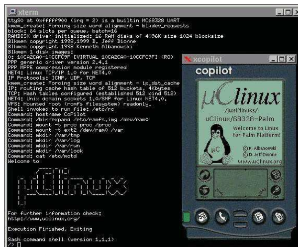
2. ábra uClinux futtatása Xcopilot alatt (Palm emulátor)
