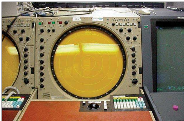
Teljesen digitális ARTS kijelző. Az ACD-k (jobb oldalon) fogják leváltani ezeket a vektorkijelzőket. Minden tekerőgomb menüben található a kijelzőn
