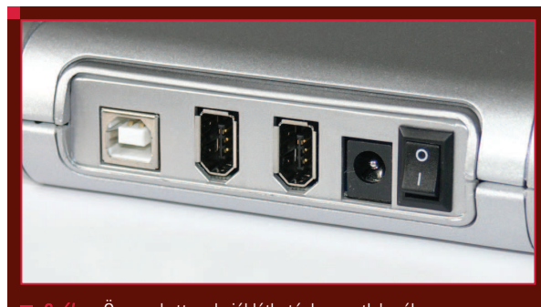
■ 3. ábra Összerakott rack, jól láthatóak a csatlakozók (USB, 2x FireWire, tápegység)
