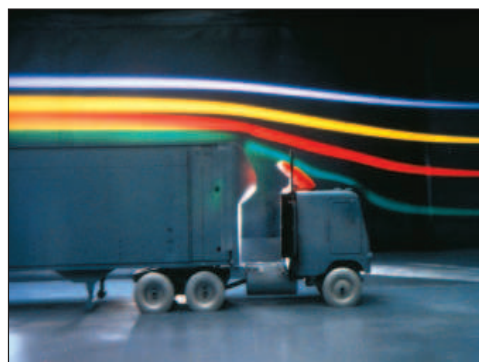
2. kép Jármű vizsgálata 2m x 3m-es szélcsatornában
