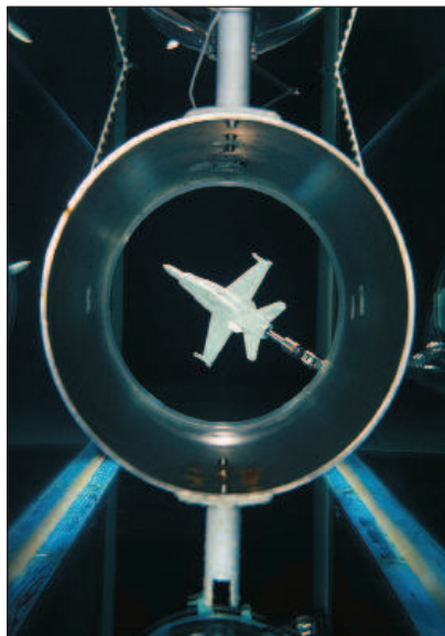
4. kép Forgó F18-as modell a vízcsatornában
