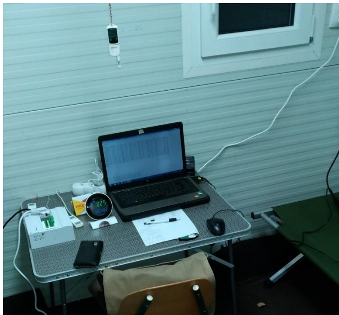
8. számú ábra. ALMEMO, EBI-300TH, Pyle és IMRe mérő/adatgyűjtő eszközök (forrás: saját felvétel)
