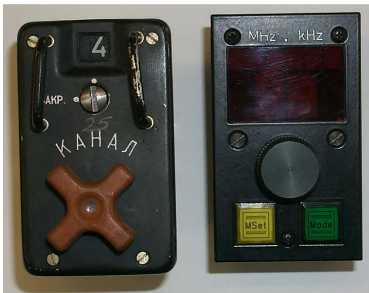
2. számú ábra. A 19-1a '3У' (ZU) mechanikus és ZU-M elektronikus hangolóblokkok egymás mellett, készítette a szerző
