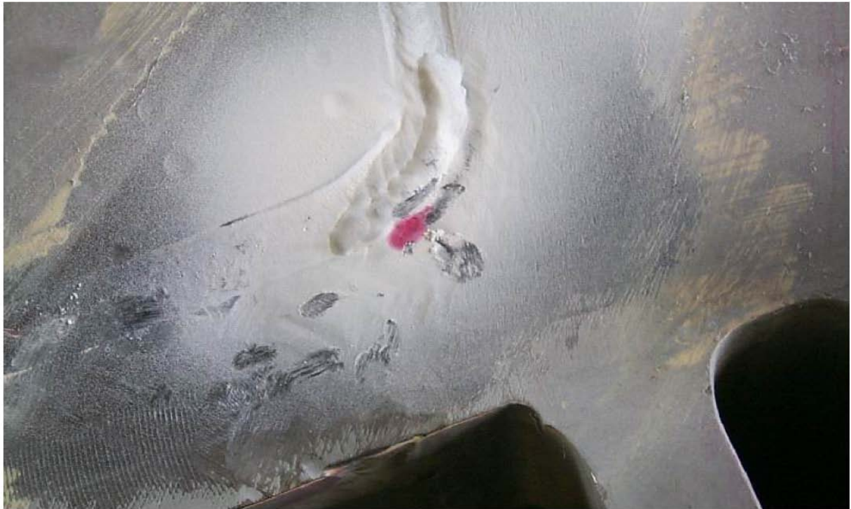
11. ábra. Repedés kimutatása egy MiG-29 típusú repülőgép törzstartályán [Gyenes G.–Svehlik J. 2006]
