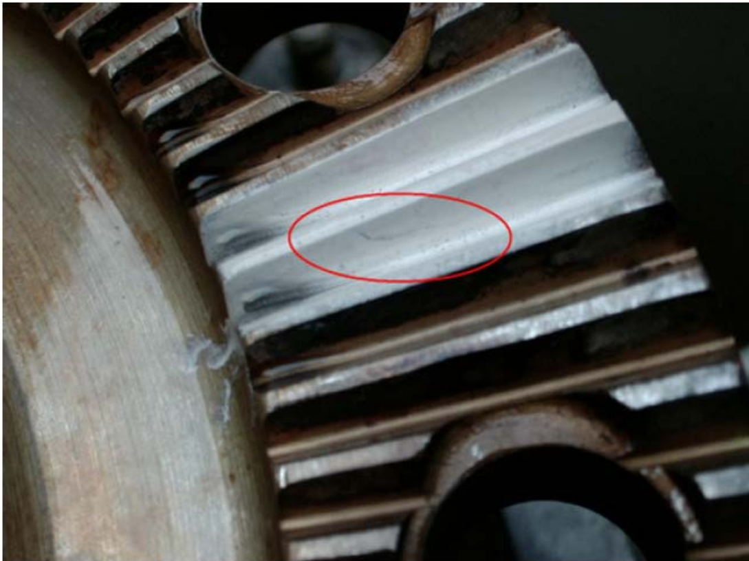
12. ábra. Repedés kimutatása egy An-26 típusú repülőgép légcsavar tengelyének Hirt-fogazású tárcsáján [Gyenes G.–Svehlik J. 2006]
