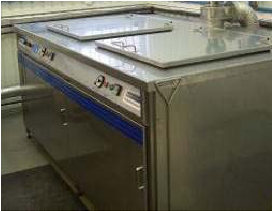
9. ábra. Finomszűrők ultrahangos tisztítására alkalmas berendezés [Forrás: MH Lé.Jü.]
