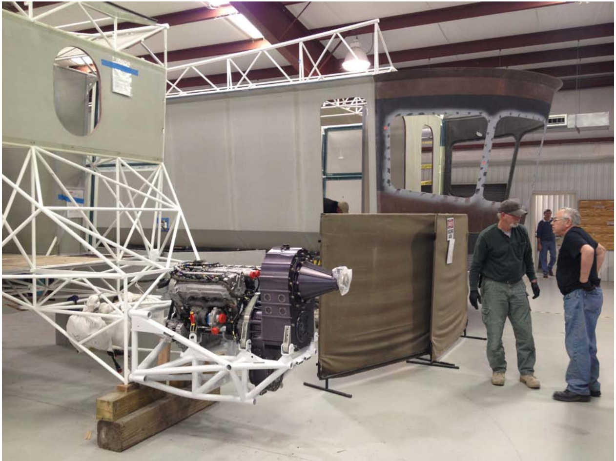
9. ábra. Léghajó dízelmotor az amerikai M-1400 típus gondola-rácsszerkezetén
