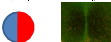
2.ábra A bal oldalon a szokásos színek jelölik az É és D pólust, a jobb oldalon a mágnesfilmmel láthatóvá tett mező. Az É és a D pólus nem különböztethető meg egymástól.
