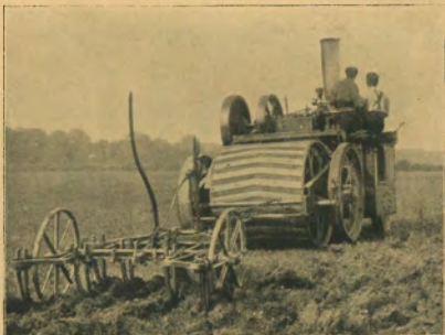
59. ábra. A Parmitter-fele gazdasági lokomotív kultivátorral végzett tarló-felérésnél.
