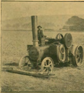
60. ábra. A Parmiter-féle gazdasági lokomotív közvetett talajművelésre felszerelve.
