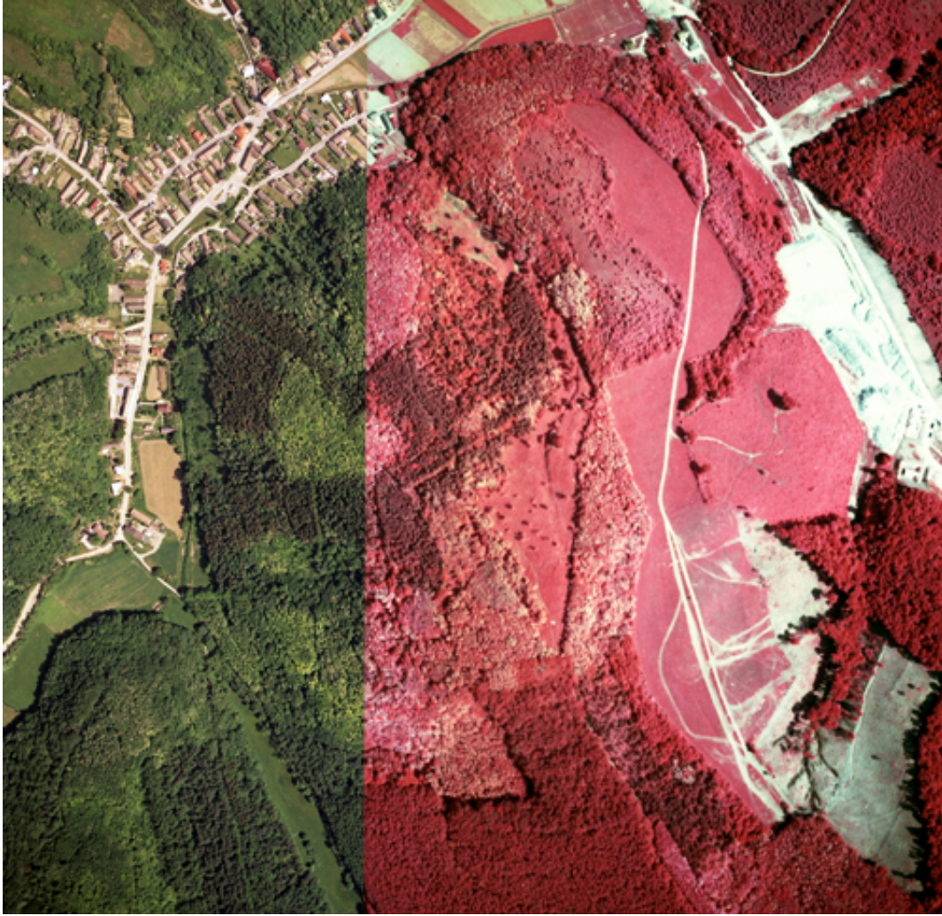
6. ábra Bármilyen spektrális tartományban készített felvételekről legyen is szó, ha a digitalizálásnál nem figyelünk a szükséges dinamikai átfogásra, vagy utólag a kontrasztfokozás érdekében "szűkre vágjuk" a hisztogramot, értékes információkat veszítünk. (Bátaapáti, 2006, színes infravörös KODAK, VITUKI ARGOS Stúdió)
