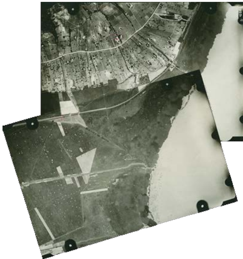
9. ábra A Balaton partja Badacsony és Szigliget között 1928-ban. Optikai kardánokkal geometriailag helyesbített (transzformált) fotómozaik két 18 x 13 cm-es felvétele. A felvételek a HM Hadtörténeti Intézet és Múzeum Hadtörténeti Térképtárának gyűjteményéből származnak.
