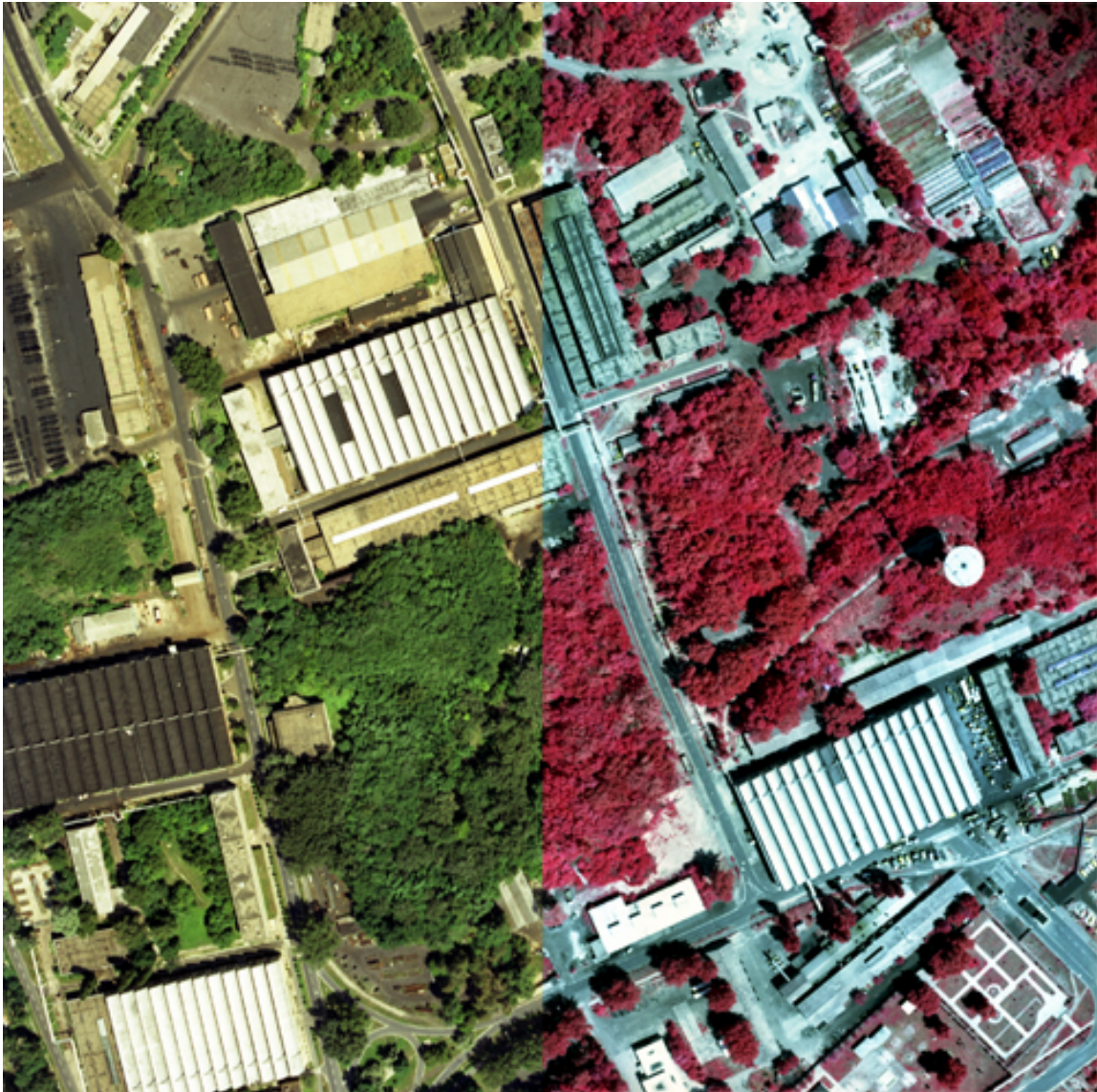
7. ábra A jó minőségű digitalizálás a helyesen exponált, és előhívott negatív esetében nem eredményez beégett és túl sötét képrészleteket. Ilyenkor hisztogram elemzés során még a sötét árnyékok is "kibonthatóak", világosíthatóak, újabb részleteket jeleníthetünk meg. A 6 x 6 cm középformátumú színes és színes infra felvételek külön készültek, és utólagosan lettek egymásra transzformálva (Csepel Autógyár, 1987, VITUKI ARGOS)
