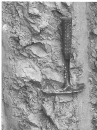
1. kép. Áthalmazott Kiscelli Agyag a B rétegtag felszíni feltárásában (a kalapács kb. 45 cm)
