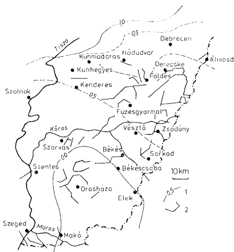
7. ábra. A kőolajkutatók során meghatározott délkelet-magyarországi törésvonalak (Zsírós T. után). Jel a magyarráza: 1. Felemelkedés 0,5 mm/év, 2. Törésvonal
