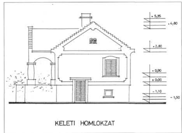
26. ábra. A Szikra utca 2. lakóház felújításának építészeti rajza. (Rajz: Debreczenyi J.) Figure 26. Ground plan and construction design of the dwelling house at number 2 Szikra street (Produced: J. Debreczenyi)
