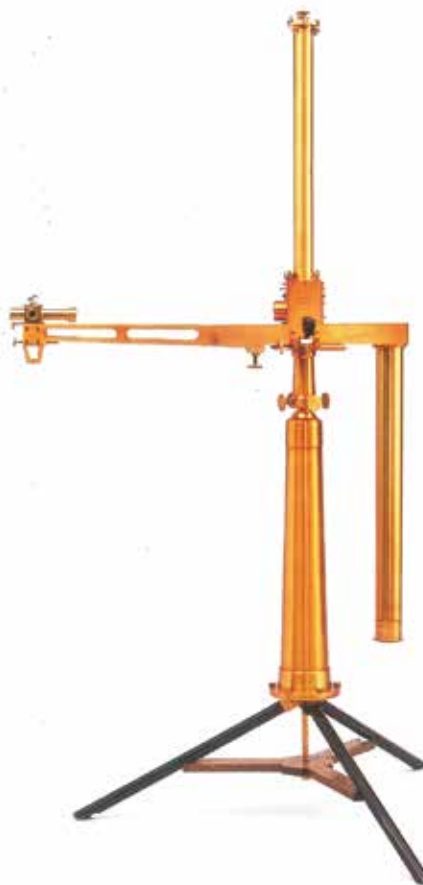
Süss Nándor által készített Eötvös-inga (horizontális variométer) The Eötvös torsion balance made by Nándor Süss (horizontal variometer) 1898
