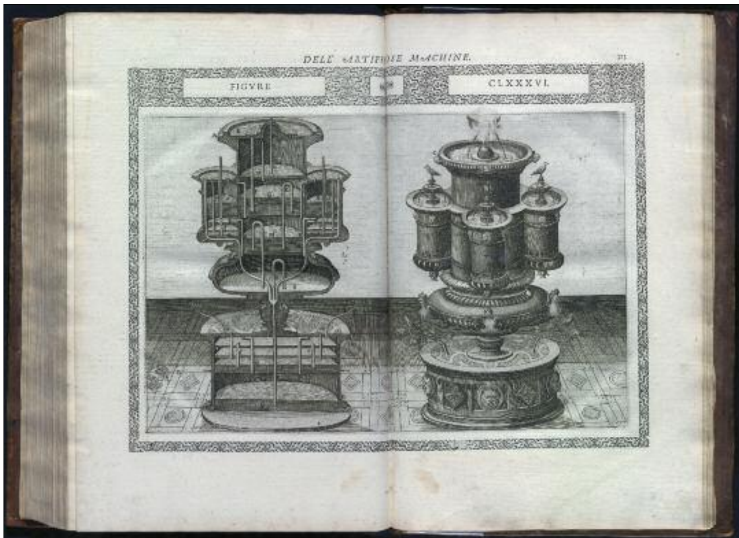
Különböző méretben készíthető zenélő csorgókút mechanikus madarakkal. Illusztráció a Le diverse et artificiose machine -ből / Musical fountain with mechanical birds, to be manufactured in various sizes. Illustration from the volume Le diverse et artificiose machine
