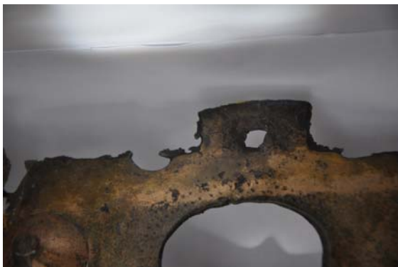
7. ábra: Utólagos lyukasztás nyomai az A-III elem téglalap alakú nyúlványán
