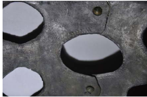
12. ábra: A poncolásnak a hátoldalon is látható nyoma a B-III elem
