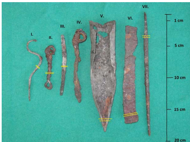
2. ábra: Vizsgált vastárgyak a mintavételi helyekkel (kivéve a IV-et) Fig. 2.: Examined iron tools with the places of samplings (except for IV)
