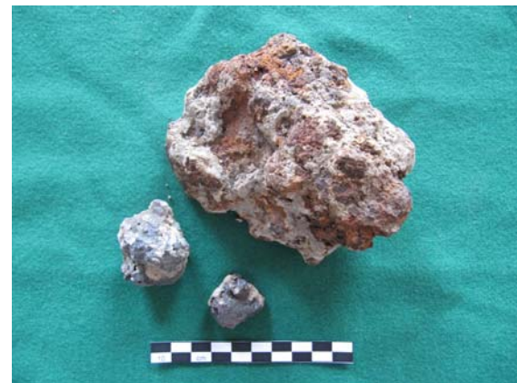
1. ábra: Vaspucából letört darab salakokkal Fig. 1.: Bloom-fragment with slag
